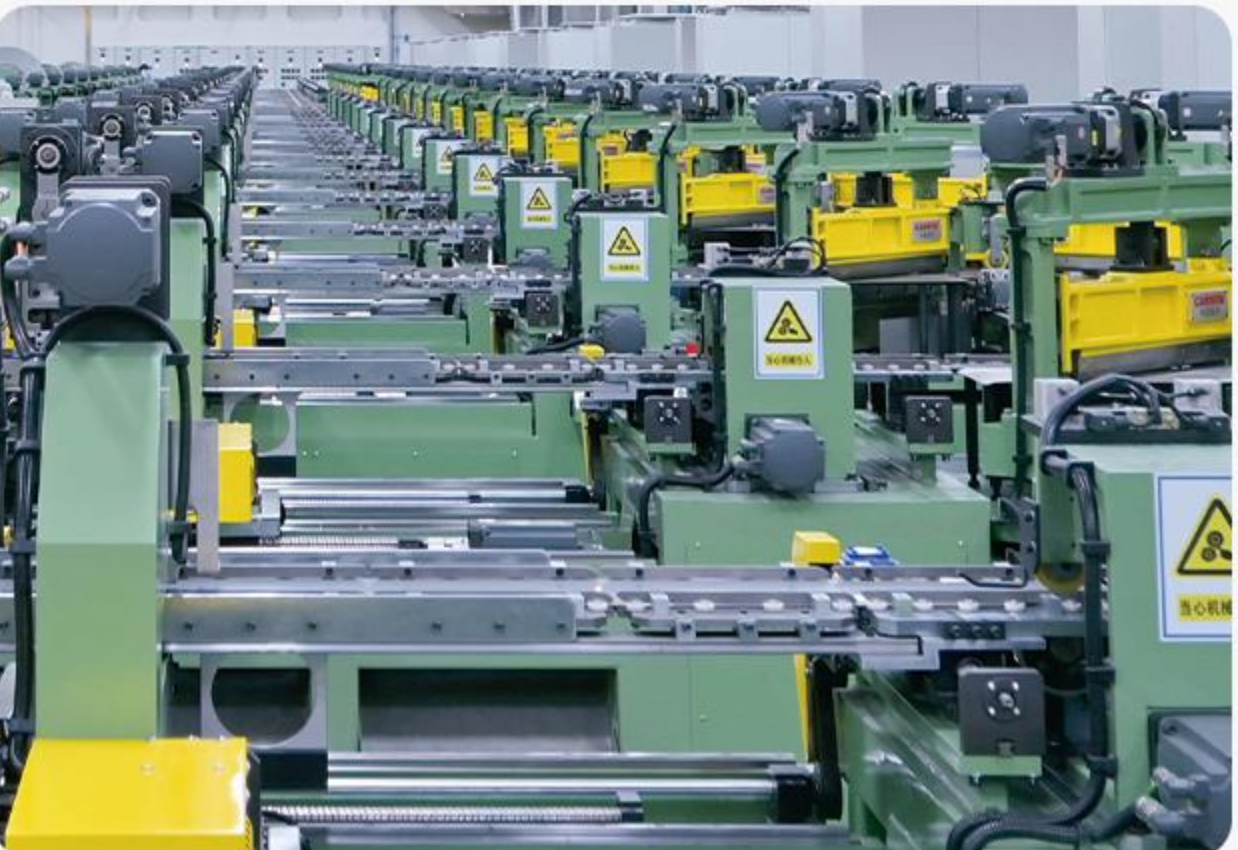
32条硅钢 自动叠片横剪线
